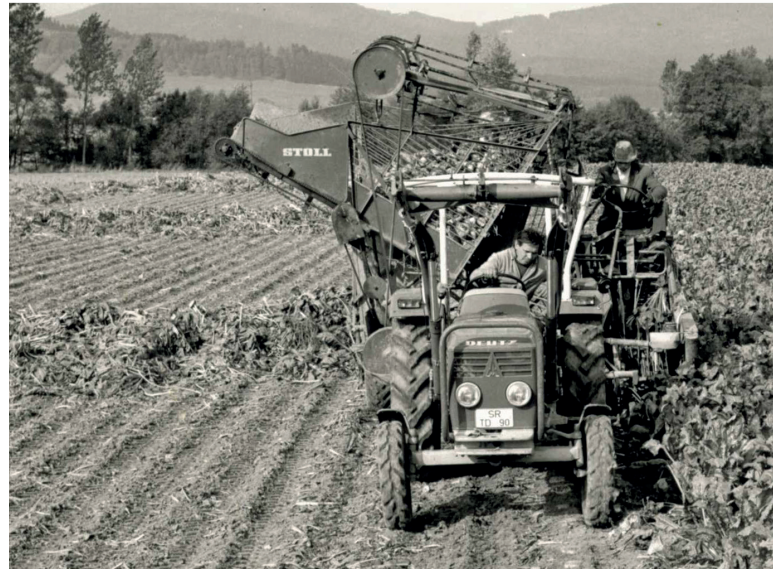
Auf dem gezogenen Zuckerrübenvollernter mussten Steuerrad und Fußhebel durch eine zweite Person bedient werden Privatarchiv Johann Eggerstorfer
